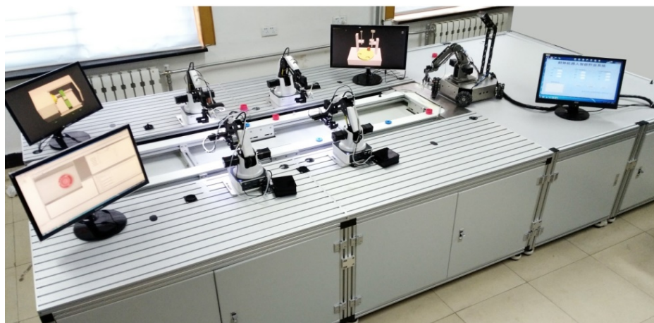
Figure 2. A flexible intelligent swarm robotic assembly system 图 2. 群机器人柔性智能装配系统
