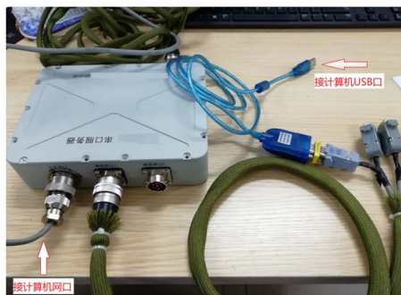
Figure 5. Connection for standard baud rate test 图 5. 标准波特率验证实验接线图
