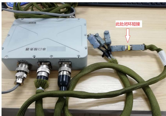
Figure 7. Connection for non-standard baud rate test 图 7. 非标准波特率验证实验接线图
