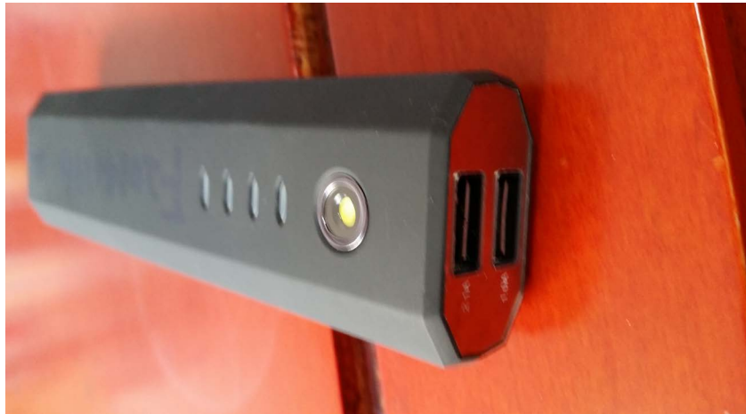
(注：该样品额定容量 10 Ah 额定能量 37 Ah，输出电压 5 V，输出端口 2 个)
