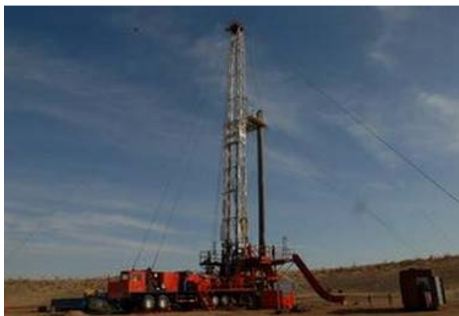
Figure 2. Wheeled workover rig in sidetracking 图 2. 在进行侧钻作业中的轮式修井机
