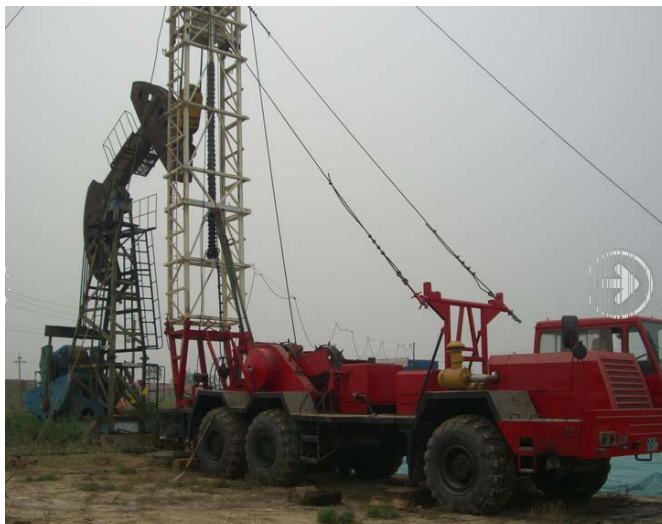
Figure 1. Wheeled tractor hoist in operation 图 1. 作业中的轮式通井机
