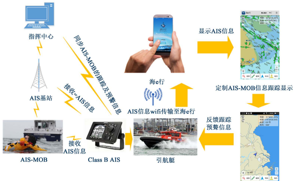
Figure 7. Push based on AIS MOB personnel drowning information 图 7. 基于 AIS MOB 人员落水信息推送
