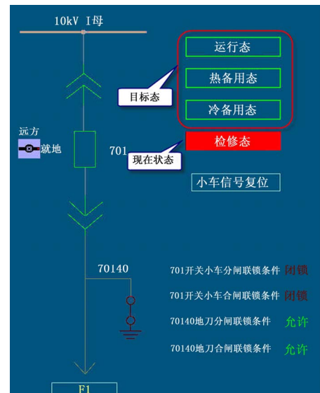
Figure 3. Sequence control of feeder line F1 图 3. 10 kV 馈线 F1 间隔程序化操作
